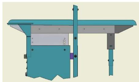
Per agevolare la stiratura di prodotti di grandi dimensioni è possibile inclinare il piano di stiratura rendendolo conforme ai criteri ergonomici, al fine di tutelare la salute fisica del lavoratore.
