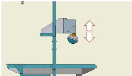
**La mensola è regolabile in altezza a seconda delle caratteristiche dell'operatore.**
