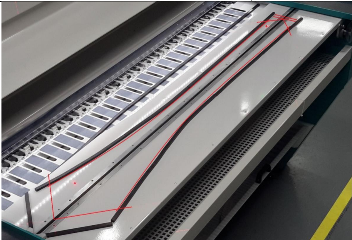
Ottica doppia linea, utilizzata per la verifica della lunghezza totale della cravatta.
