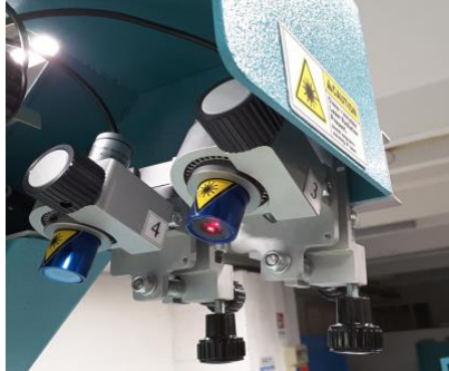
Ottica a linea, due per ogni lato macchina utilizzati per la centratura della seta
