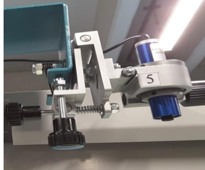
Ottica a punto, uno per lato utilizzati per la centratura di loghi o marchi.
