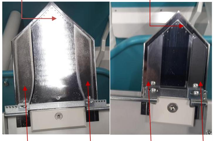
Su richiesta può essere aggiunto sistema di bloccaggio lamellare per stiratura di cravatte a due lati.
