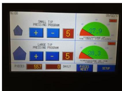
**Il pannello "touch" consente di dialogare con l'unità centrale permettendo la gestione di tutti i parametri di funzionamento della macchina.**
