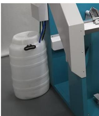
**L'acqua per il generatore di vapore incorporato viene prelevata dal bidone da 50 litri, fornito con la macchina, oppure è possibile collegarla direttamente alla rete idrica.**
