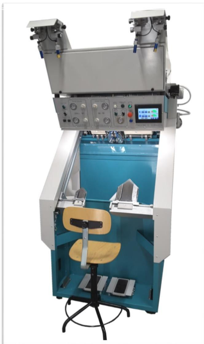
Nico 4 è una macchina per la stiratura delle punte delle cravatte a piastre indipendenti, a doppio sistema di bloccaggio a lamelle e vacuum pump. Estremamente facile da utilizzare, sistema vaporizzante con generatore di vapore incorporato, a basso consumo energetico.
