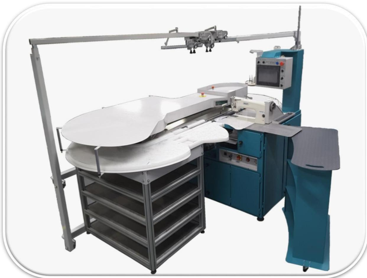
FC Evo è una macchina per la cucitura delle punte della cravatta, studiata con cura meticolosa in ogni singolo particolare al fine di ottenere la massima qualità del prodotto, funzionalità e semplicità d'utilizzo, mantenendo sempre le caratteristiche di affidabilità e precisione che hanno contraddistinto le macchine realizzate dalla Frigerio e Corazza.
